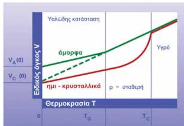
**Εικ. 3:** Διάγραμμα πίεσης, όγκου και θερμοκρασίας για άμορφα και ήμι - κρυσταλλικά υλικά
