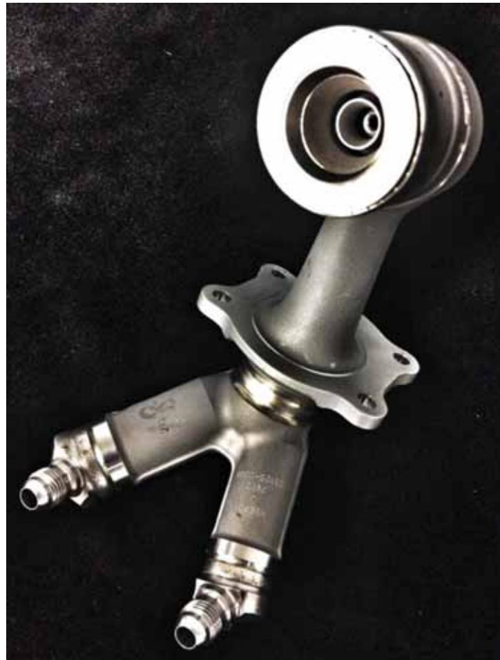
Το 3D ακροφύσιο του κινητήρα Jet που κατασκευάζεται με 3D εκτυπωτή μετάλλου από την GE.
