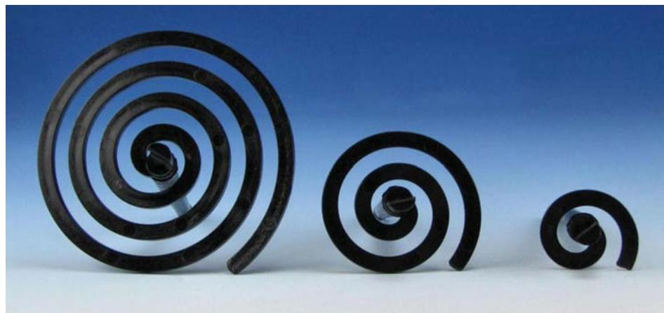
Εικ. 3: Δείγματα ροής από διάφορα θερμοπλαστικά υλικά
