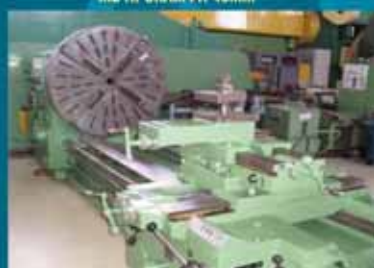
ΠΛΑΤΟΤΟΡΝΟΣ RAVENSBURG 3000mm ΠΛΑΤΟ 1300mm ΓΩΝΙΑΤΑ 1620mm
