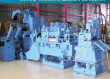
ΡΙΕΦΕΡ ΓΡΑΜΜΗ ΙΣΙΩΜΑΤΟΣ ΚΑΙ ΚΟΠΗΣ COIL ΠΑΧΟΣ από 2 έως 10mm, ΦΑΡΔΟΣ 500mm.
