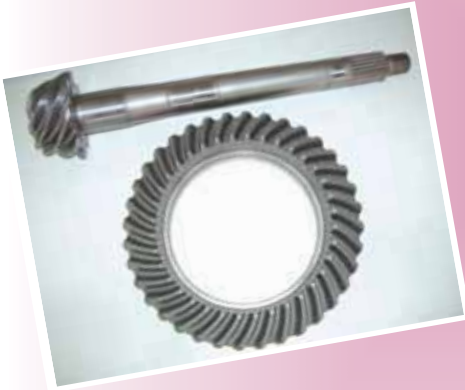
Ζευγάρι υποειδών, κωνικών, ελικοειδών γραναζιών κορώνας - πηνίου, διαφορικού αγωνιστικού αυτοκινήτου NISSAN.
