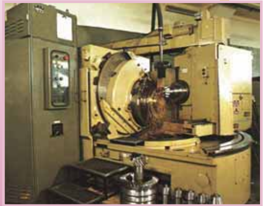
Γραναζοκόπτης ZFTKK 500/2 τύπου CURVEX κωνικών, ελικοειδών, οδοντωτών τροχών, διαμέτρου μέχρι και 750 mm και μετάδοσης από 1:1 μέχρι και 1:10.
