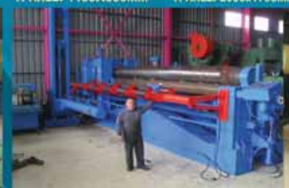
ΚΥΛΙΝΔΡΟΣ SCHAFER 5,5m 13mm ΥΔΡΑΥΛΙΚΟΣ DIGITAL ΠΡΟΚΑΜΨΗ
