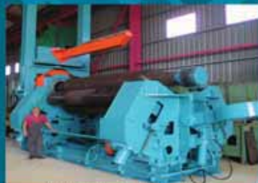
ΚΥΛΙΝΔΡΟΣ ΛΑΜΑΡΙΝΑΣ 3m 70mm ΜΕ ΠΡΟΚΑΜΨΗ 40mm
