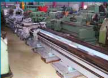
ΤΟΡΝΟΣ ΡΟΡΕΒΑ TRK-90 ΜΗΚΟΣ 10.000mm ΔΙΑΜΕΤΡΟΣ 900mm
