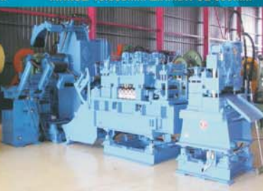
ΡΙΕΦΕΡ ΓΡΑΜΜΗ ΙΣΙΩΜΑΤΟΣ ΚΑΙ ΚΟΠΗΣ COIL ΠΛΑΧΟΣ από 2 έως 10mm, ΦΑΡΔΟΣ 500mm.
