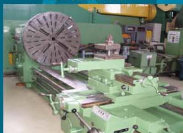
ΠΛΑΤΟΤΟΡΝΟΣ RAVENSBURG 3000mm ΠΛΑΤΟ 1300mm ΓΟΝΑΤΙΑ 1620mm
