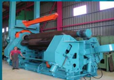
ΚΥΛΙΝΔΡΟΣ ΛΑΜΑΡΙΝΑΣ 3m 70mm ΜΕ ΠΡΟΚΑΜΨΗ 40mm
