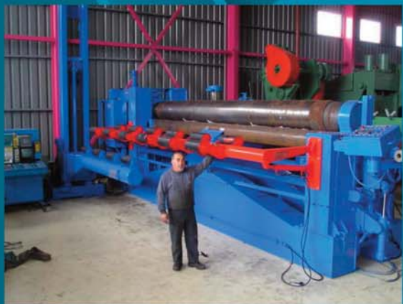
ΚΥΛΙΝΔΡΟΣ SCHAFFER 5,5m 13mm ΥΔΡΑΥΛΙΚΟΣ DIGITAL ΠΡΟΚΑΜΨΗ
