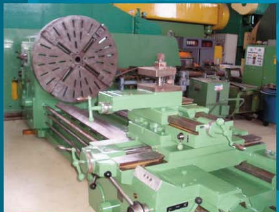
ΠΛΑΤΟΤΟΡΝΟΣ RAVENSBURG 3000mm ΠΛΑΤΟ 1300mm ΓΟΝΑΤΙΑ 1620mm
