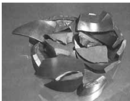
Εικ. 12: Καταστροφή ηλεκτροδίου από γραφίτη
