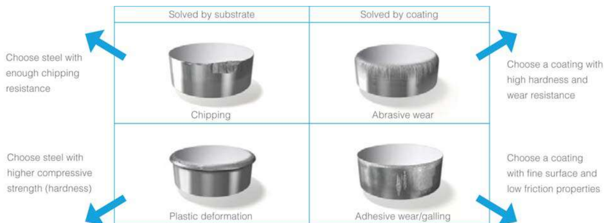
Εικόνα 3. Τύποι αστοχίας εργαλείων «εν ψυχρώ» εφαρμογών
