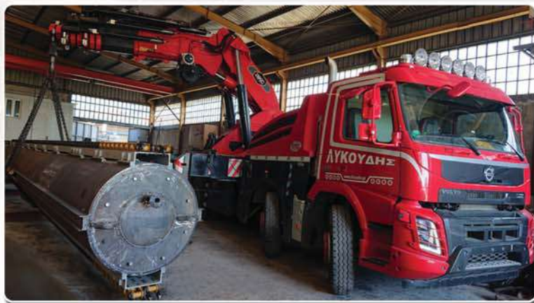
Ανύψωση σε κλειστό χώρο ποδαρικού πλοίου 28τ
