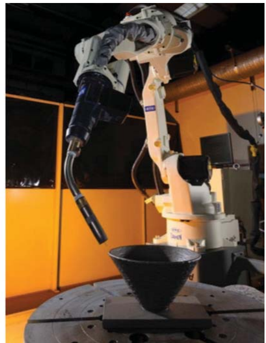
Εικ. 3: Σκαρίφημα και χαρακτηριστική διάταξη συστήματος Wire-arc Energy Deposition σε ρομποτικό βραχίονα πολλαπλών αξόνων
