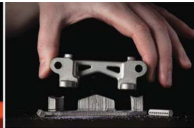
Μεταλλικό κομμάτι μετά την αφαίρεση των δομών υποστήριξης
