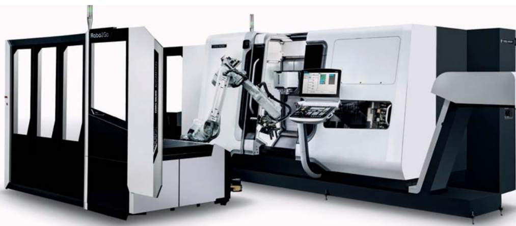
ΕΙΚ. 3: Η CTX beta 1250 TC με αυτοματισμό Robo2Go Vision.
