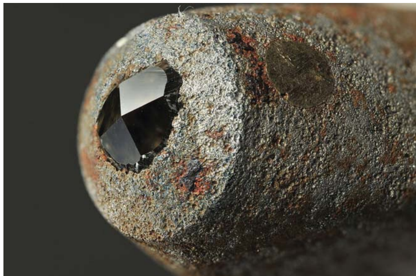
Εικ. 20: Εισβολέας από διαμάντι για τη μέτρηση σκληρότητας με τη μέθοδο Vickers.
