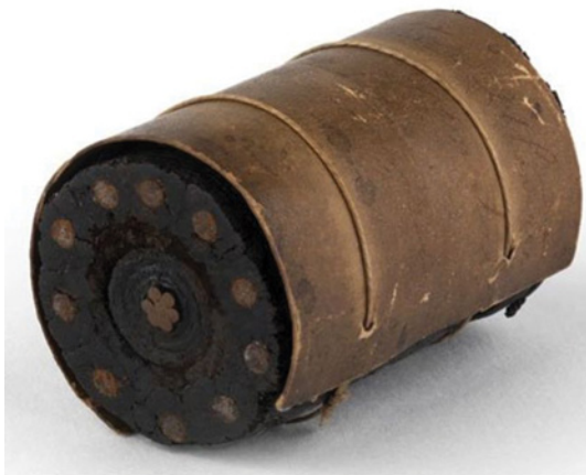
Εικ. 4: Τμήμα υποβρυχίου τηλεπικοινωνιακού καλωδίου επικαλυμμένου με γουταπέρκα.
