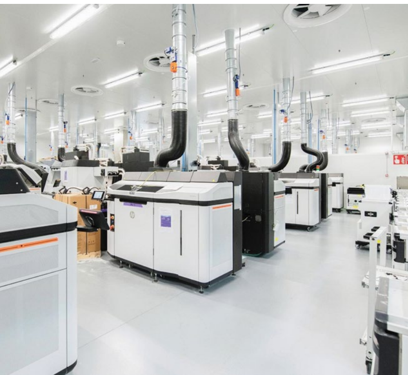
3D Εκτυπωτές, HP Jet Fusion 5200 στο Κέντρο τρισδιάστατης εκτύπωσης της HP στην Βαρκελώνη [Πηγή: HP]
