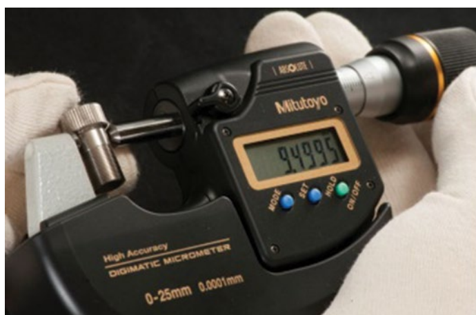
Σχήμα 15: Μικρόμετρο υψηλής ακρίβειας με 4 δεκαδικά.
