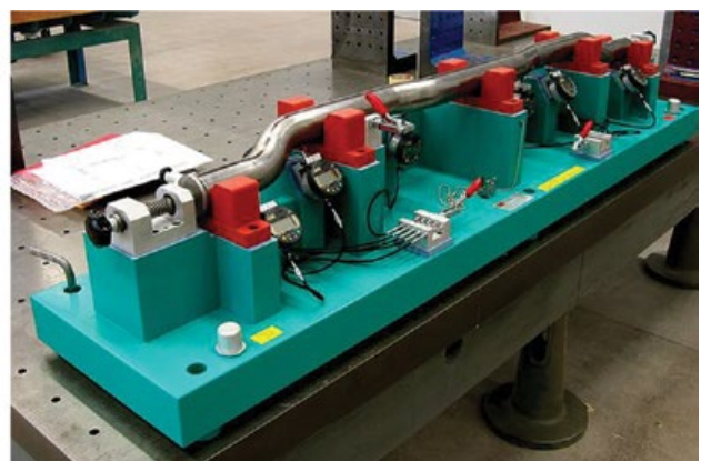
Σχήμα 5: Μετρητική διάταξη με ψηφιακά ρολόγια.
