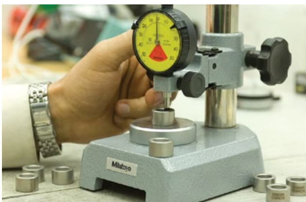
Σχήμα 4: Μέτρηση με ρολόι γράφτη επάνω σε σταθερή βάση.
