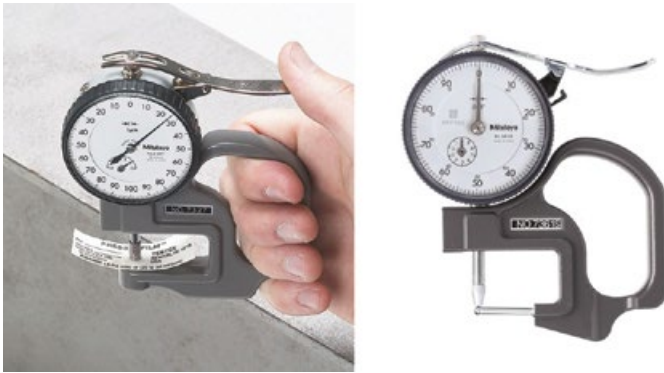
Σχήμα 9: Ωρολογιακό παχύμετρο (αριστερά για χαρτί, δεξιά για πάχος σωλήνων).
