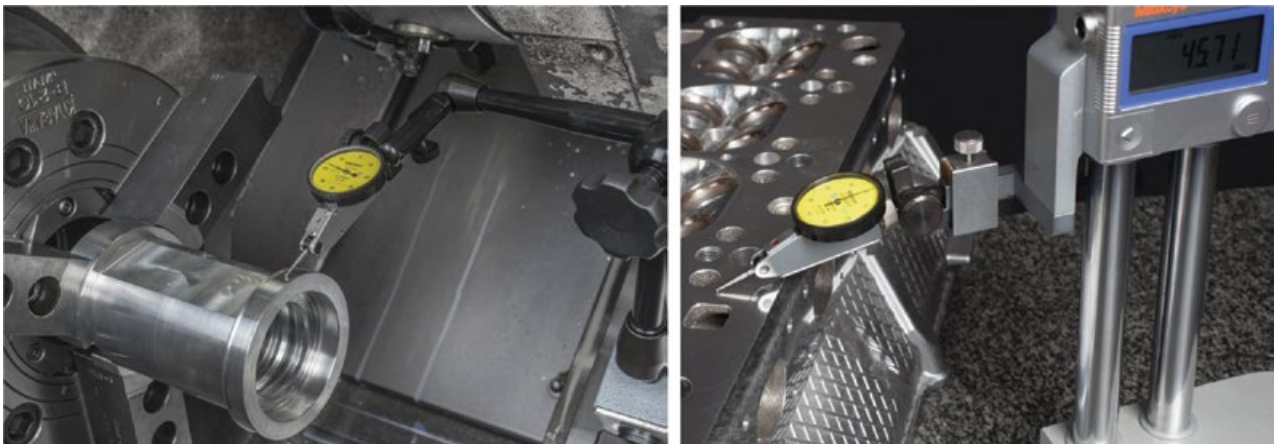
Σχήμα 12: Εφαρμογές του ρολογιού κεντραρίσματος (αριστερά κεντράρισμα, δεξιά έλεγχος επιπεδότητας).
