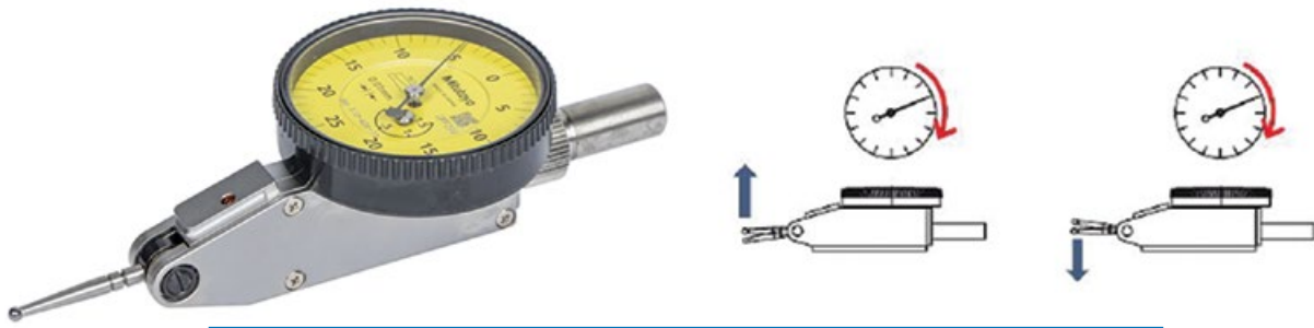
Σχήμα 11: Λειτουργία του ρολογιού κεντραρίσματος σε δύο διευθύνσεις.
