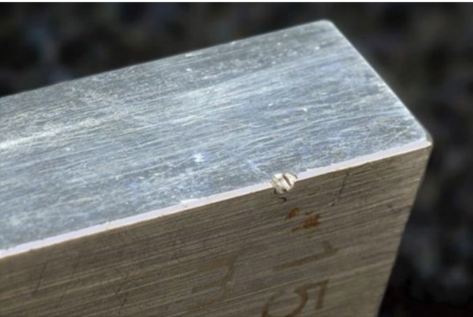
Σχήμα 8: Πρότυπο πλακίδιο με έντονα σημάδια φθοράς.
