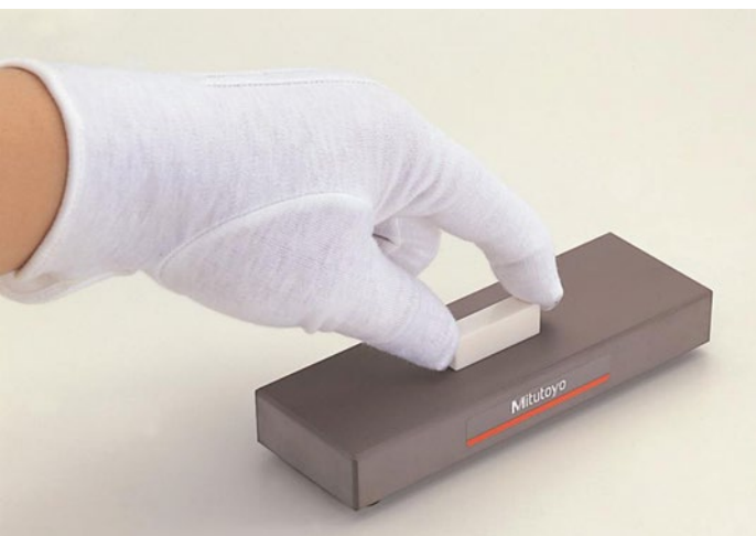
Σχήμα 10: Χειροκίνητη λείανση πλακιδίου επάνω σε πέτρα Ceraston.
