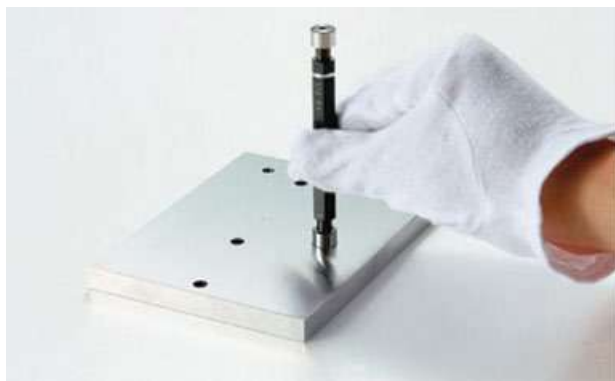
Σχήμα 1: Η βασική αρχή του ελέγχου με τη βοήθεια των ελεγκτών ορίων σε κυλινδρικό τεμάχιο.
