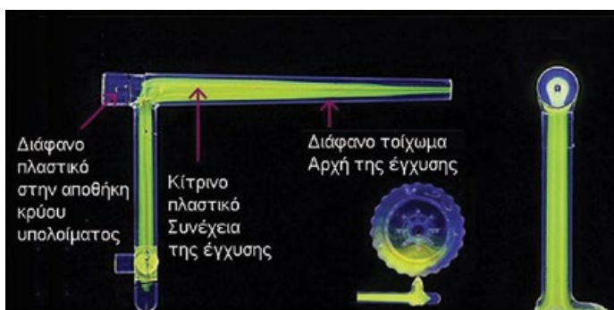
Εικ. 3: Απόδειξη ροής συντριβανιού κατά την αλλαγή χρώματος.
