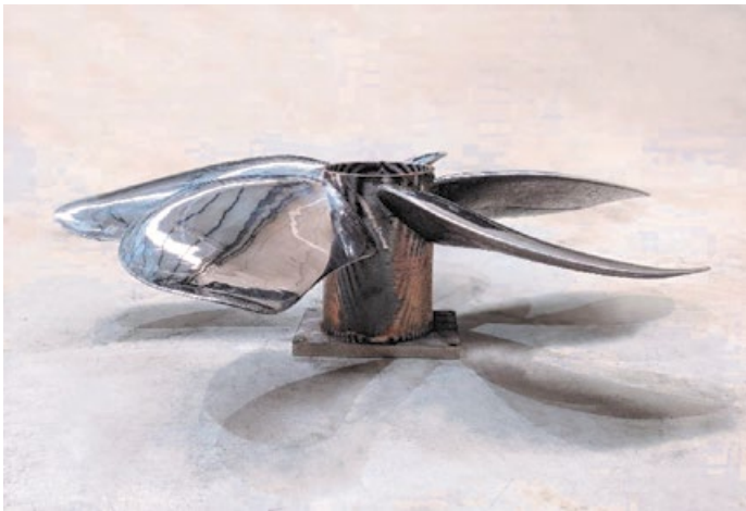
Part-polished προπέλα, εκτυπωμένη με διαφορετικά orientation ανά τμήμα, για βέλτιστες μηχανικές ιδιότητες.
