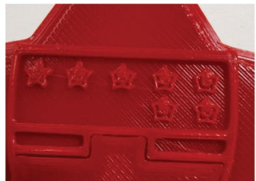
Εικ. 6: Λεπτομέρεια γεωμετρίας μικρών διαστάσεων που απέτυχε η εκτύπωση.
