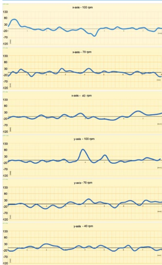
Εικ. 6: Ενδεικτικά προφίλ τραχύτητας επιφανείας για διάφορες ταχύτητες.
