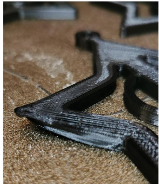
Εικ. 19: Φαινόμενο συρρίκνωσης του υλικού κατά την εκτύπωση. Σημαντικό ρόλο παίζει και η θερμοκρασία του τραπεζιού
