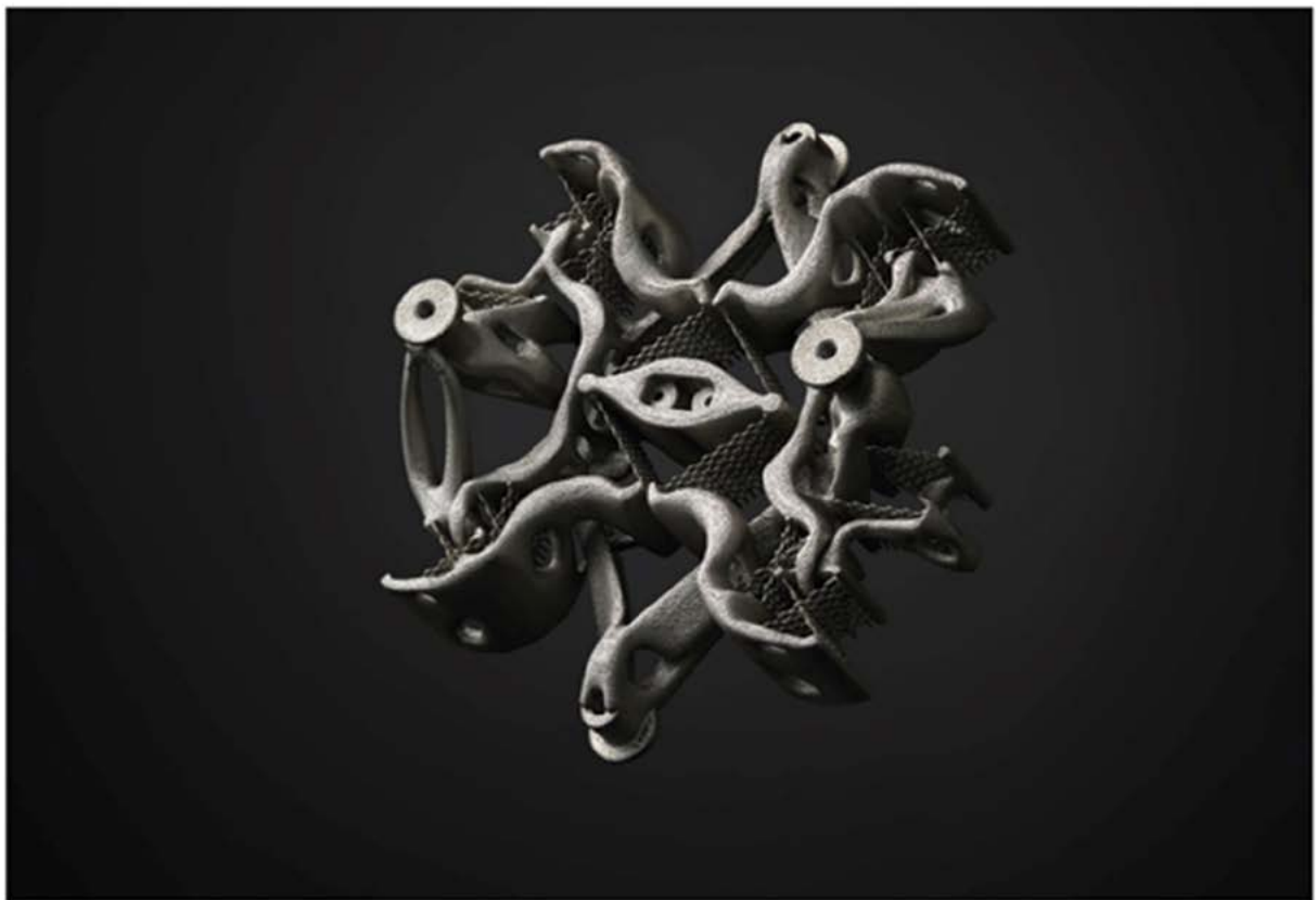
Εικόνα 4: Παράδειγμα πολύπλοκης γεωμετρίας που ο μοναδικός τρόπος κατασκευής είναι η προσθετική κατασκευή. Πνευματικά δικαιώματα εικόνας από το antalthoma.ch
