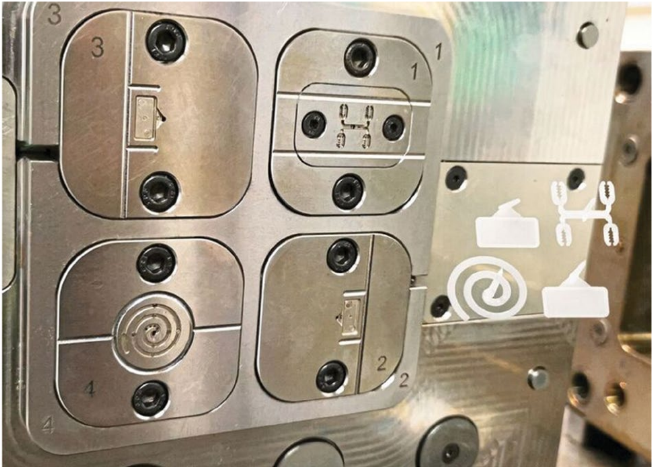
Οικογενειακό (με παρόμοια αντικείμενα) καλούπι με τέσσερις διαφορετικές μονάδες έγχυσης και ατομική πύλη (Πηγή: Kuz)
