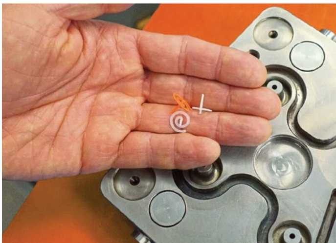
Εξισορρόπηση του διανομέα τήγματος με το παράδειγμα μιας σπείρας ροής. (Πηγή: Hasco)
