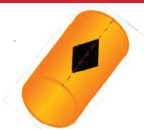
Σχήμα 13: Σχηματική αναπαράσταση αποτυπώματος της μεθόδου Vickers επάνω σε κυλινδρικό δείγμα.
