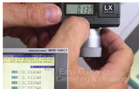
Σχήμα 8: Ρύθμιση μικρομέτρου του τραπεζιού για τη διαδικασία του centering and leveling. Το λογισμικό της συσκευής μας υποδεικνύει ακριβώς τις μετακινήσεις.
