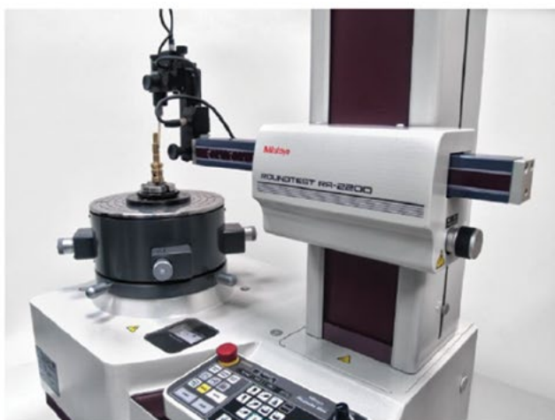
Σχήμα 2: Roundtest RA-2200 της MITUTOYO (αριστερά) και λεπτομέρεια της ακίδας του (δεξιά).
