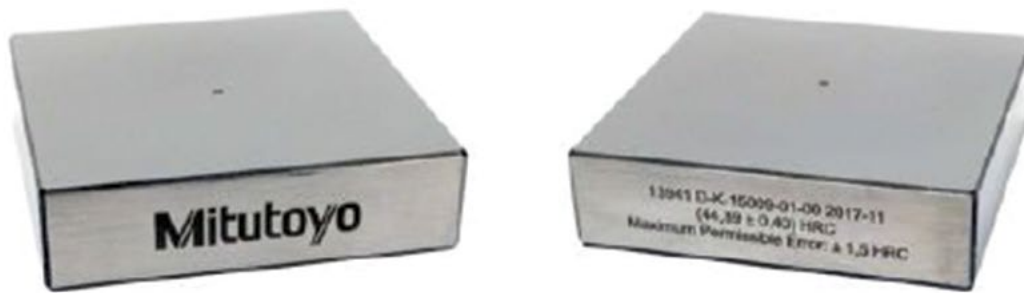
Σχήμα 7: Πρότυπα πλακίδια σκληρότητας (hardness test blocks) για διακρίβωση σκληρομέτρων.
