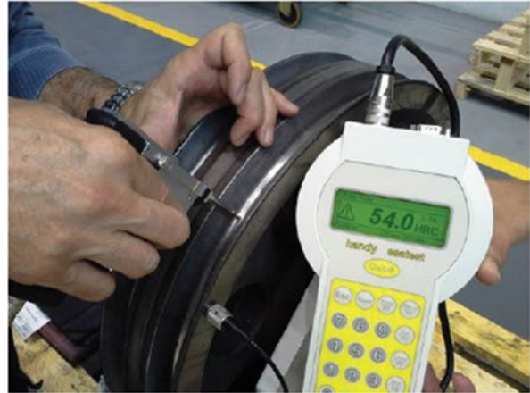
Σχήμα 2: Φορητό σκληρόμετρο αναπήδησης (αριστερά) και διείσδυσης (δεξιά).
