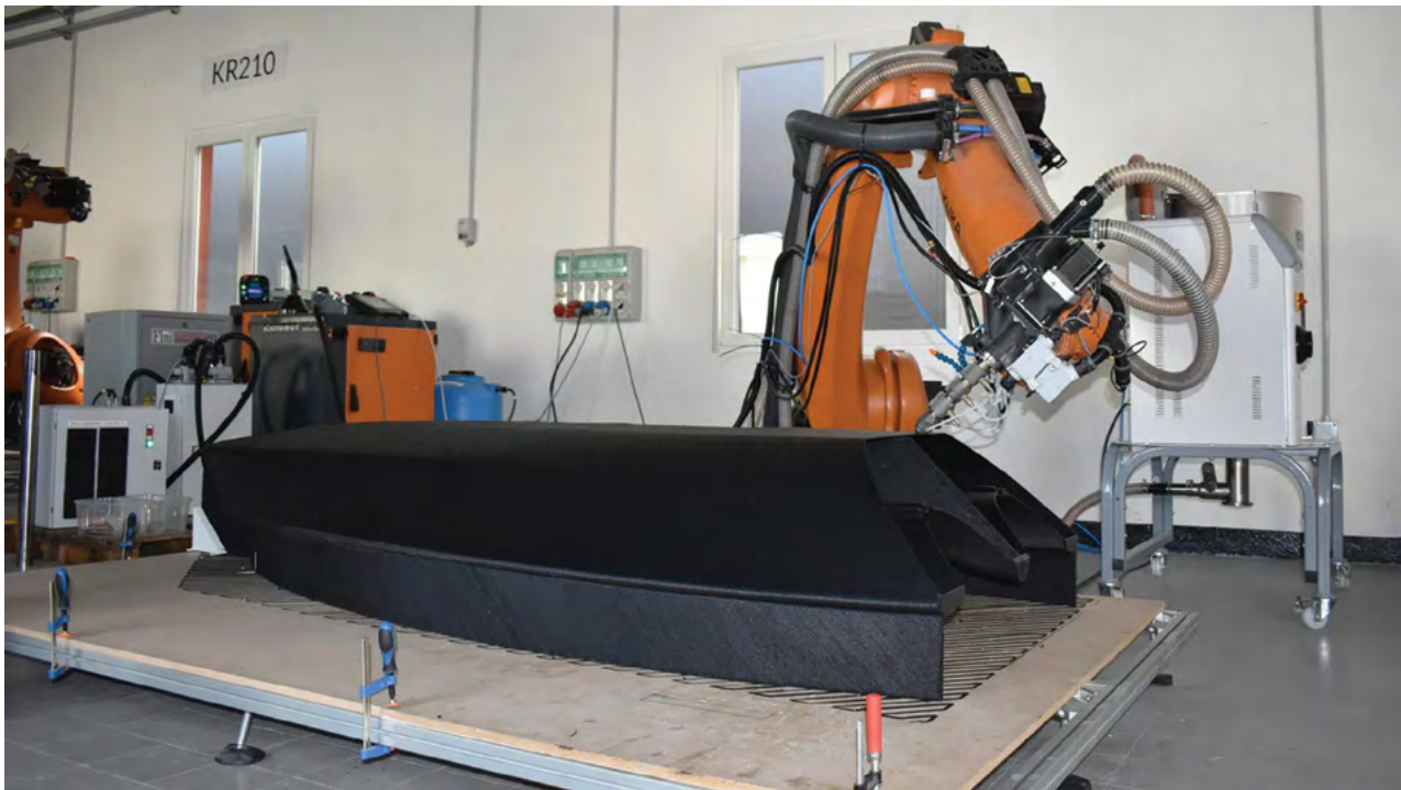
Η πλατφόρμα προσθετικής κατασκευής μεγάλων διαστάσεων (LFAM) HeronAM 3δεκτυπώνει το πρωτότυπο σκάφος ιστιοπλοίας.
