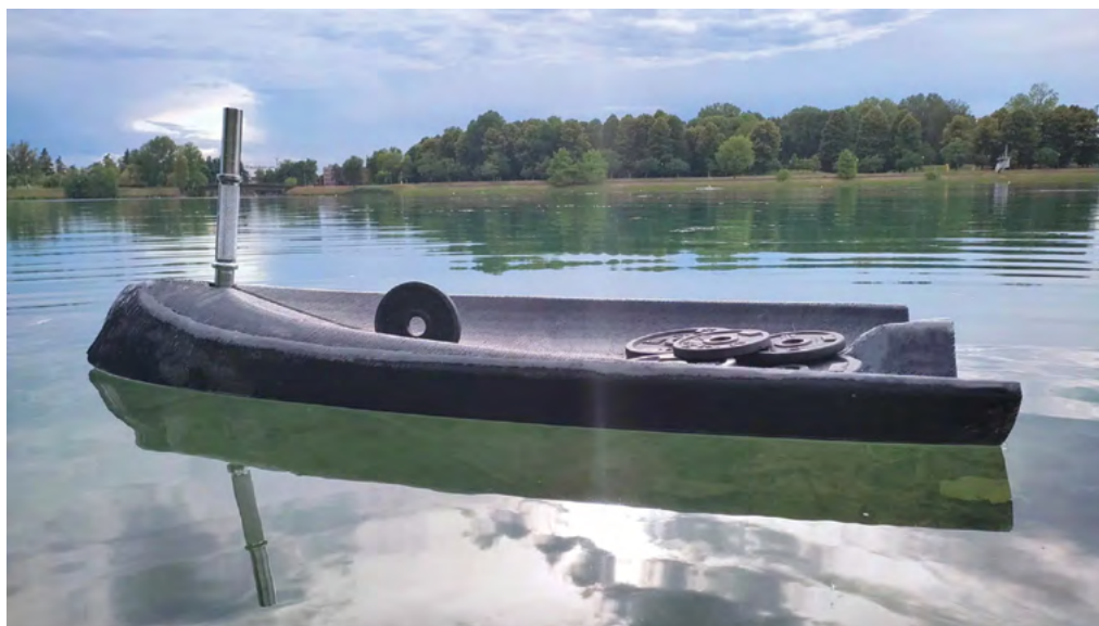
3D εκτυπωμένο κομμάτι 1:2 για δοκιμή άνωσης.
