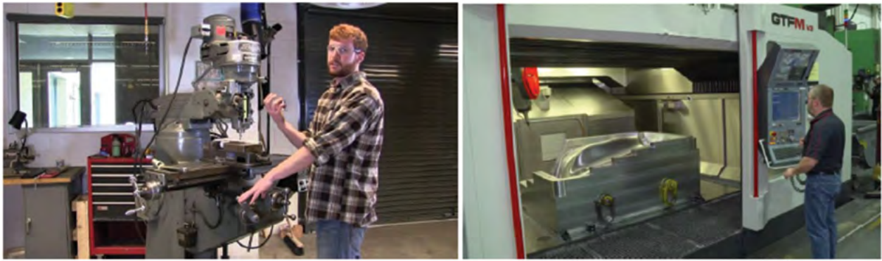
Εικόνα 9: Φρέζα CNC (δεξιά) και συμβατική (αριστερά) Εικόνα 10. Σχηματική αναπαράσταση της διάτρησης.
