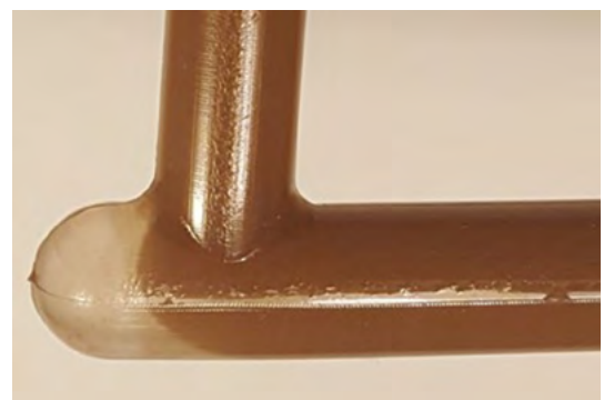
Εικ. 9: Επιπλέον υπερχειλίσση στο κανάλι ροής τήγματος.
