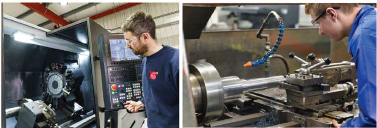
Εικόνα 6: Τόννος CNC (αριστερά) και συμβατικός (δεξιά).
