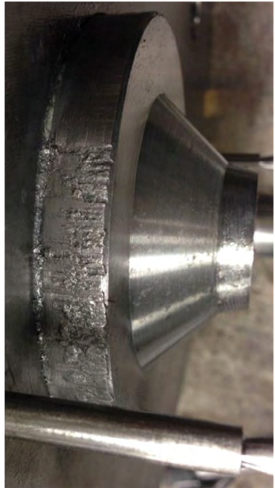
Εικ. 6: Γρανιάρισμα δαχτυλίου μπουκαδούρας.
