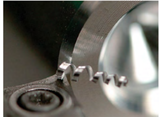
Εικ. 1: Κατεργασία με αφαίρεση υλικού
