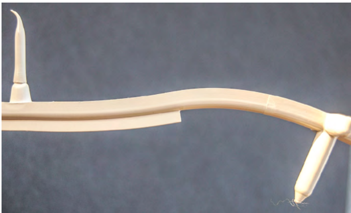
Εικ. 3α: Νεύρο ενίσχυσης για αποφυγή παραμορφώσεων.
