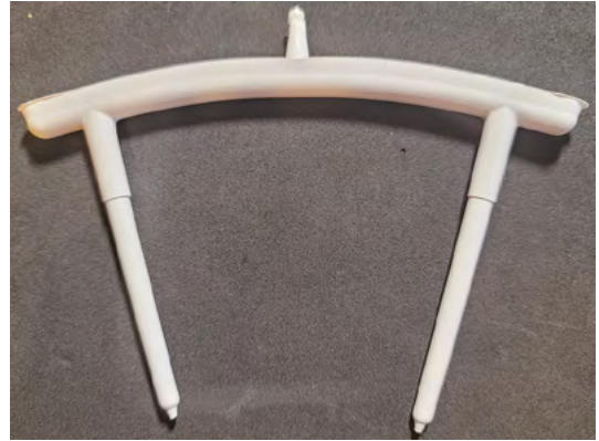
Εικ. 2: Παραμορφωμένη μπουκαδούρα καλουπιού με τρεις πλάκες.
