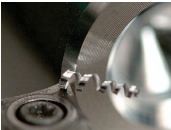
Εικ. 1: Ένθετο κοπτικό πλακίδιο τόννου.
