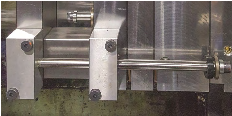
Εικ. 7: Τηλεσκοπικός άξονας για τον έλεγχο κίνησης πλακών τοποθετημένος εκτός καλουπιού.
