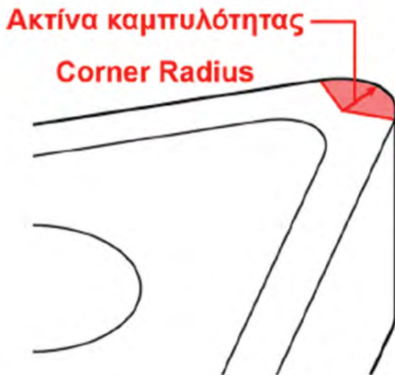
Εικ. 10: Ακτίνα καμπυλότητας (ράδιο) ένθετου πλακιδίου τόννου.
