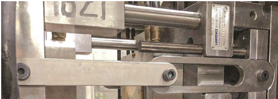
Εικ. 10: Ράβδος ελέγχου διαδρομής τηλεσκοπικού τύπου.
