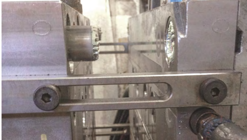
Εικ. 9: Ράβδος ελέγχου διαδρομής απλού τύπου.
