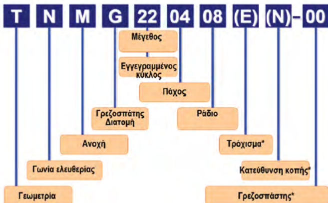
Εικ. 17: Ονοματολογία ένθετων κοπτικών τόννου.
