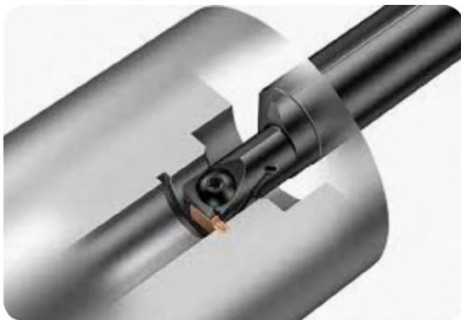
Εικ. 7: Εσωτερική (αριστερά) και εξωτερική (δεξιά) αυλάκωση.
