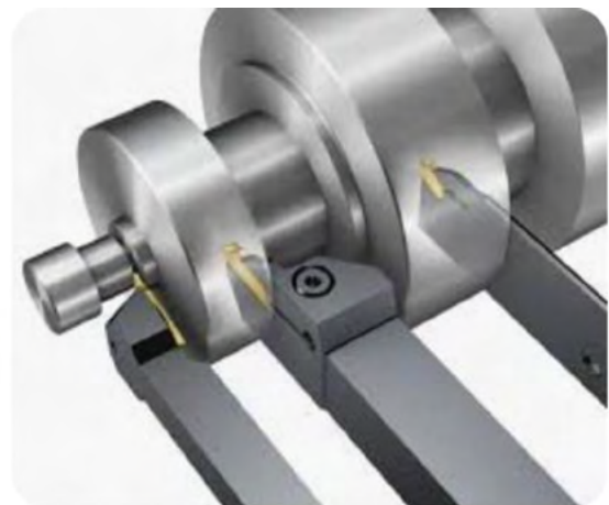
Εικ. 7: Εσωτερική (αριστερά) και εξωτερική (δεξιά) αυλάκωση.
