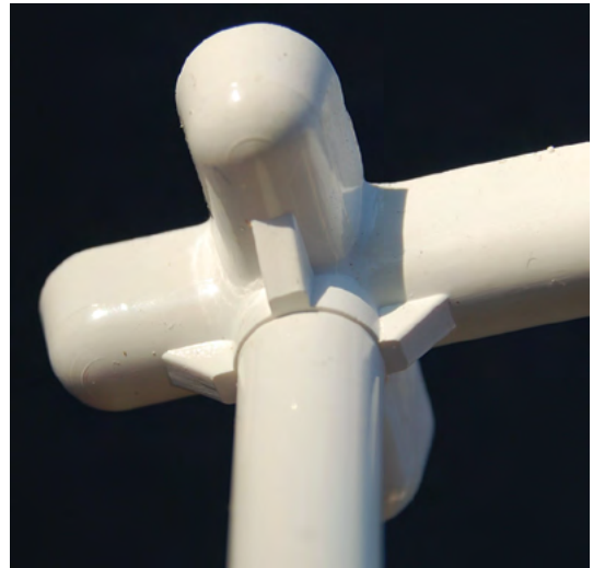
Εικ. 3: Ενίσχυση κάθετου καναλιού τροφοδοσίας
