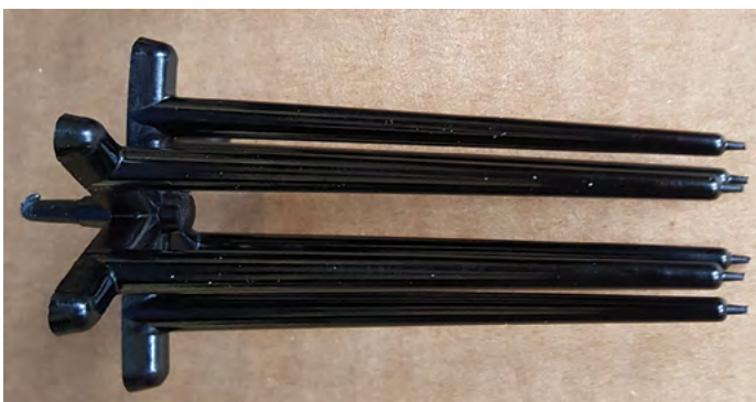
Εικ. 7: Πολλαπλή κάθετη τροφοδοσίας σε μικρού ως μεσαίου μεγέθους εξαρτήματα
