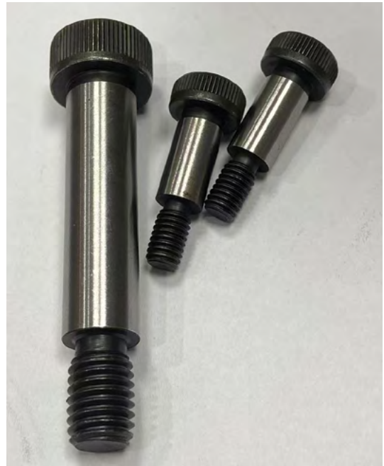
Εικ. 4: Κοχλίες με ρεκτιφιαρισμένο στέλεχος σύμφωνα με το ISO7379
