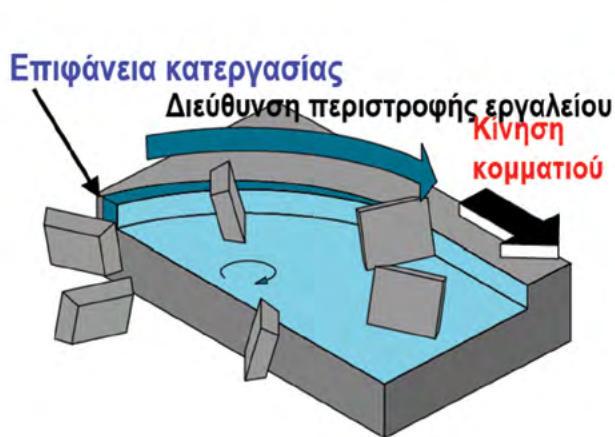
Σχηματική αναπαράσταση του down milling
