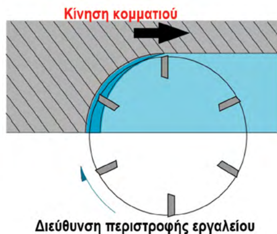
Σχηματική αναπαράσταση του down milling
