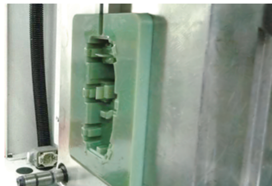
Κοιλότητα του καλουπιού έγχυσης που έχει εκτυπωθεί με 3D εκτύπωση.
