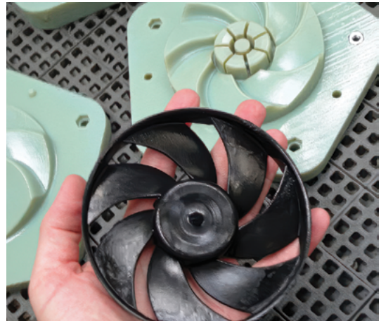
Πτερωτή από ακετάλη, χυτευμένη με έγχυση με χρήση καλούπιού εκτυπωμένο σε 3D (φόντο).
