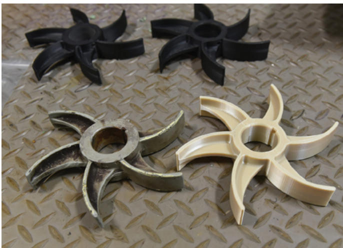
Μια μεταλλική (σπασμένη) πτερωτή, αριστερά, τα εκτυπωμένα πρωτότυπα, επάνω, και το εκτυπωμένο πλαστικό (PEI) ανταλλακτικό της, δεξιά [1]
