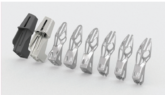
Τα στάδια εξέλιξης στον σχεδιασμό της εκτυπωμένης στήριξης οροφής του BMW i8 [8]
