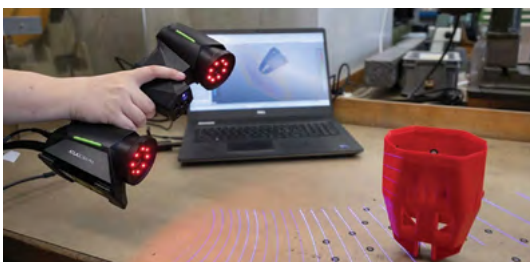
Atlascan Pro — για εφαρμογές αεροδυναμικής, αυτοκινητοβιομηχανίας και ναυπηγικής (Πηγή: Scantech/Scanology)
