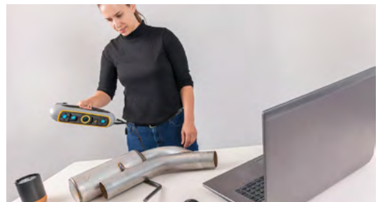
peel 3.CAD — από σάρωση απευθείας σε επεξεργάσιμο CAD αρχείο (Πηγή: peel 3D)
