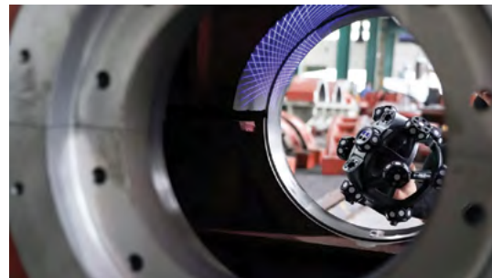
Scantech NimbleTrack — optical tracking και laser scanning σε ένα σύστημα (Πηγή: Scantech/Scanology)
