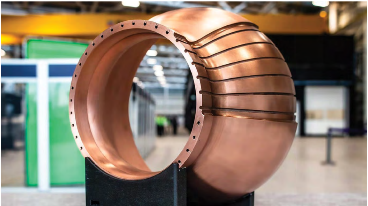
Λεπτομέρεια χάλκινου ακροφυσίου — εσωτερική δομή cold spray (Πηγή: NMIS)
