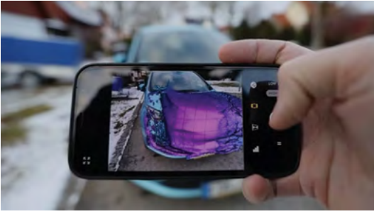
iPhone Pro με LiDAR — το smartphone ως τρισδιάστατος σαρωτής (Πηγή: Crosslink via YouTube)
