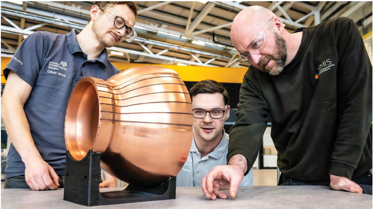
Χάλκινο ακροφύσιο πυραύλου κατασκευασμένο με high-pressure cold spray — NMIS, Σκωτία 2026 (Πηγή: NMIS)
