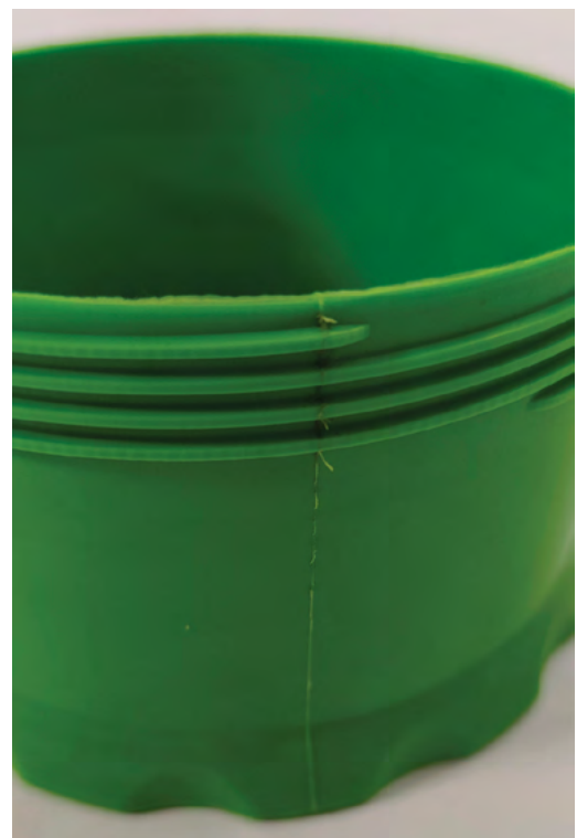
Προϊόν από δοκιμαστικό καλούπι με σκοπίμως έντονη γραμμή ένωσης
