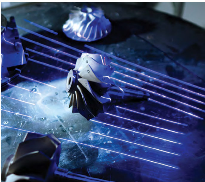
Σάρωση πολλαπλών τεμαχίων με ZEISS T-SCAN hawk 2
