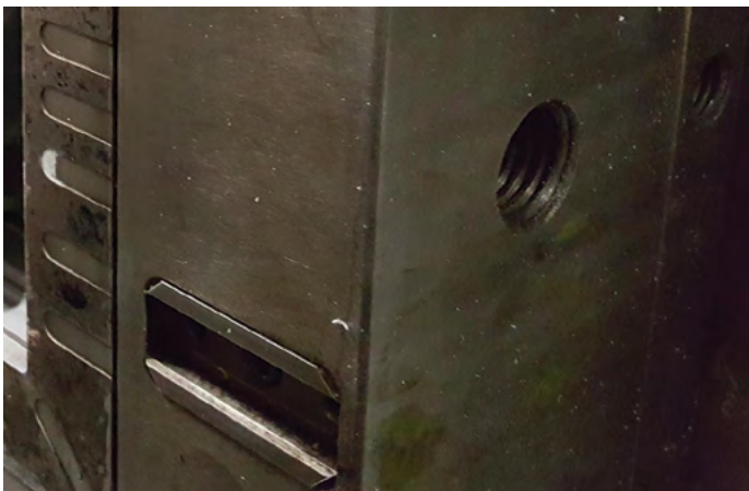
Εικ. 3: Σωστή τοποθέτηση ορθογωνικών κεντραριστικών σε καλούπι
