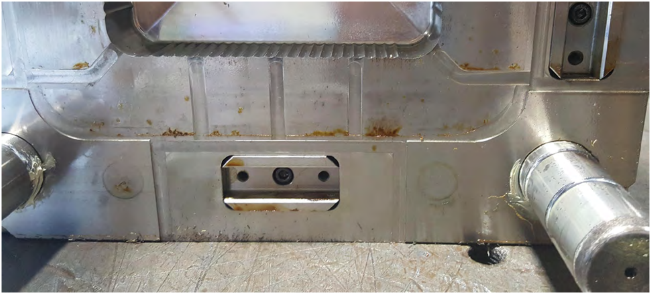
Εικ. 4: Μη προτεινόμενη τοποθέτηση ορθογωνικών κεντραριστικών σε καλούπι
