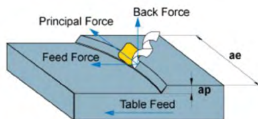
Εικόνα 2. Οι δυνάμεις που αναπτύσσονται στο φρεζάρισμα
