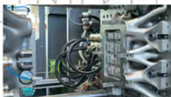
Καλούπι κατασκευασμένο εξ' ολοκλήρου με προσθετική κατασκευή
