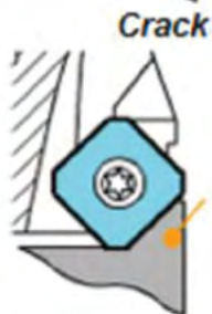
Εικόνα 4. Ένθετα ειδικά για το φρεζάρισμα χυτοσίδηρου και την αποτροπή σπασιμάτων στο κομμάτι
