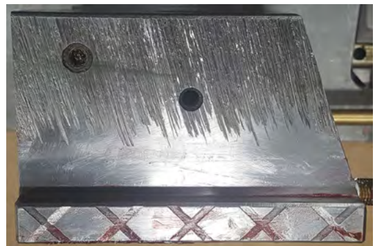
Εικ. 8: Πλευρική φθορά σε συρτάρι λόγω κακής ευθυγράμμισης
