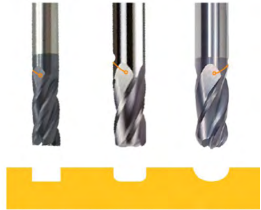
Εικ. 3: Από αριστερά προς τα δεξιά: ίσιο κονδύλι, κονδύλι με ράδιο στις γωνίες και σφαιρικό κονδύλι
